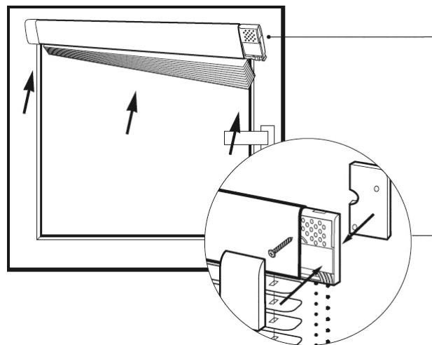
5. Просверлить два отверстия в нижнем штапике.
